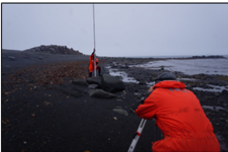
Figura 4. Instalación y nivelación de sensores de nivel del mar durante la Expedición Antártica 2024 -2025.
